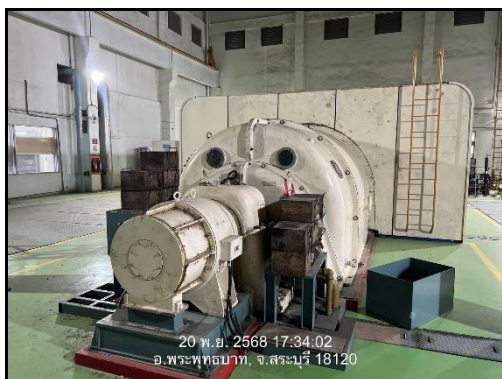
ภาพที่ 2.12 อุปกรณ์ครอบแหล่งกำเนิดที่ก่อให้เกิดเสียงดัง
