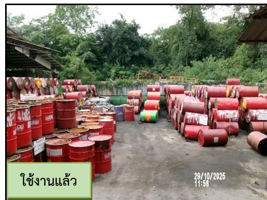
ภาพที่ 2.19 บริเวณพื้นที่ถังเก็บน้ำมันหล่อลื่นขนาด 200 ลิตร พร้อมฝาปิดมิดชิด
