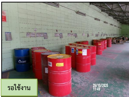
ภาพที่ 2.19 บริเวณพื้นที่ถังเก็บน้ำมันหล่อลื่นขนาด 200 ลิตร พร้อมฝาปิดมิดชิด
